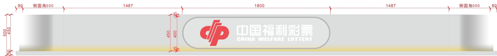
500mm 高烤漆板造型门头长度尺寸规范示意图
