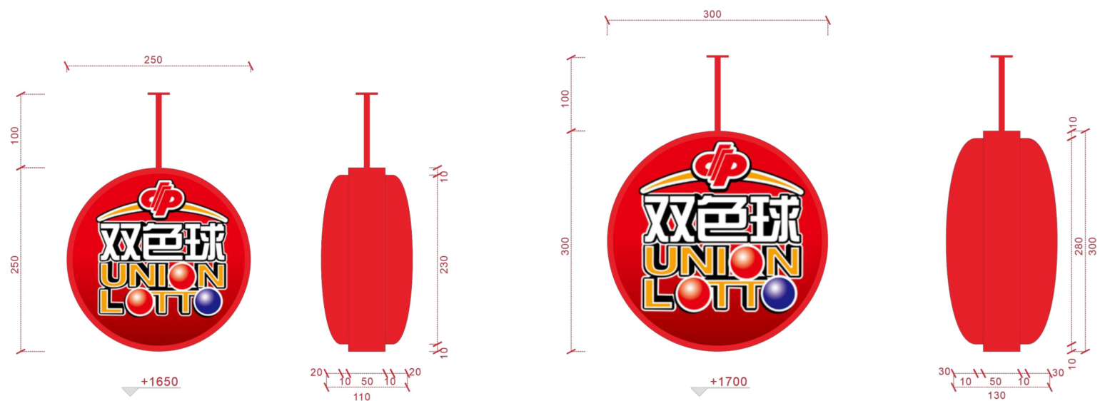
400mm高造型门头配置吸塑灯箱尺寸图
