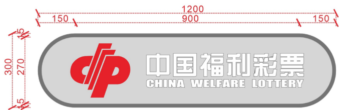
烤漆板造型门头剖面尺寸图
