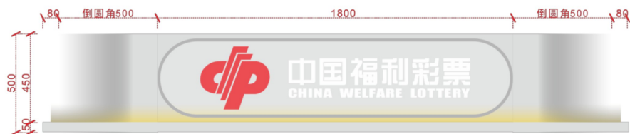
500mm高烤漆板造型门头长度尺寸规范示意图（中岛式放置）
